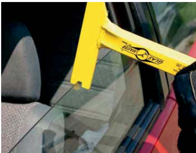
Einfaches und sicheres Brechen der Seitenscheiben mit dem Glasbrecher.
