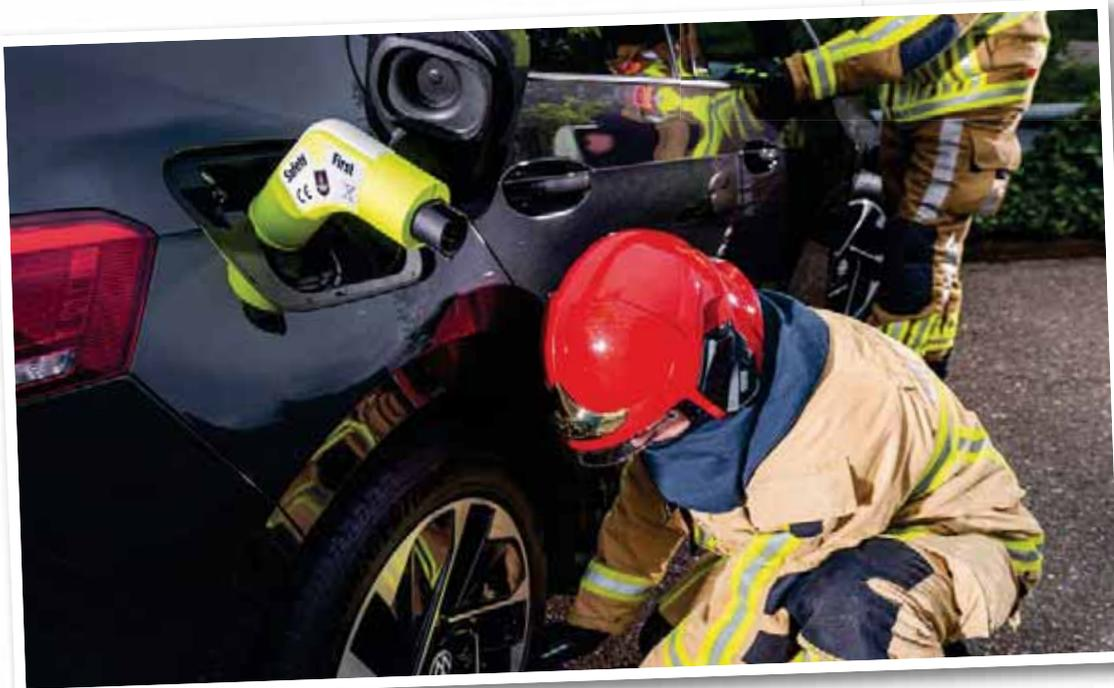
Mit einem Handgriff blitzschnell gesichert: Der Emergency Plug wird in den Ladeanschluss gesteckt und legt so automatisch den Motor still.
