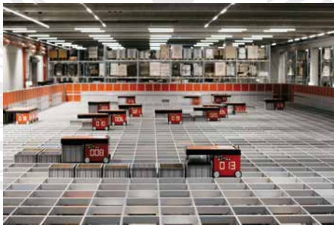
Unser hocheffizienter Autostore nutzt einen kubischen Aufbau aus 30.000 gestapelten Einheitsbehältern, um die Ware per Roboter schnellstmöglich bereitzustellen.
