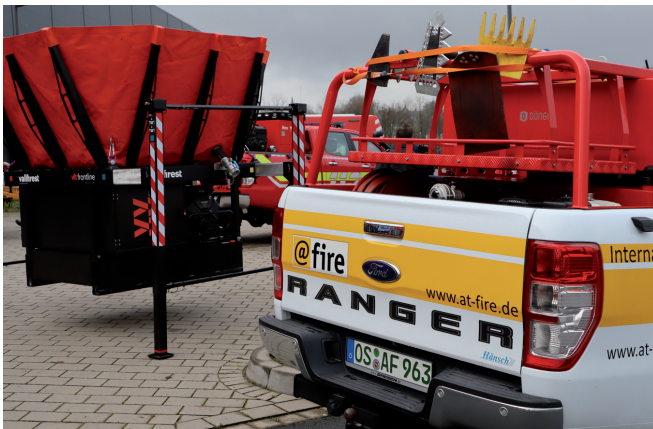
links oben: Ford Ranger 2.0 TDCI XLT 4 × 4, ausgerüstet von Rotte Brandschutztechnik mit Vallfire-Skid-Unit mit Membranpumpe AR813 rechts oben: Polaris Sportsman 570 6 × 6 EPS, ausgerüstet vom Dönges-Partner »Quad am Ring«. Das Fahrzeug kann alternativ zur Schleifkorbtrage mit einer Löscheinheit ausgestattet werden. links unten: @fire-Ford Ranger mit Vegetationsbrandmodul von Vallfire. Auf einer Halterung sind verschiedene Handwerkzeuge verlastet. Links daneben: Vallfire-Heliskid mit faltbarem Segeltuchtank mit einem Fassungsvermögen von 3 000 Litern. rechts unten: Fahrzeug von Pepec ausgestattet mit einem abnehmbaren Schnellgriffsmodul und einer Vallfire-Hochdruckpumpe mit 320-Liter-Löschwasserbehälter
